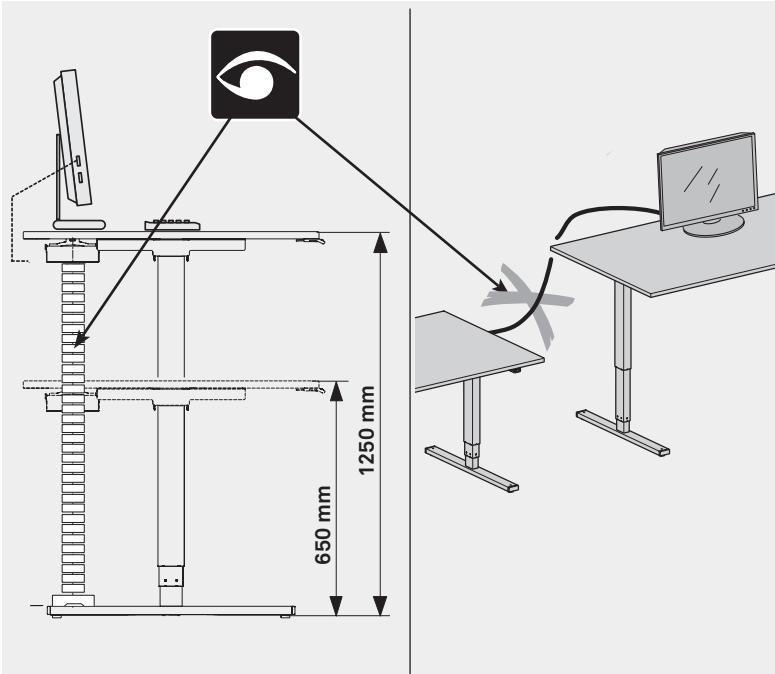
Kabelverbindungen (CPU zu Monitor usw.) sind auf genügend Länge zu prüfen.
