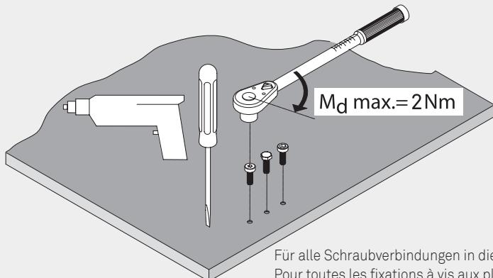
Für alle Schraubverbindungen in die Platten
