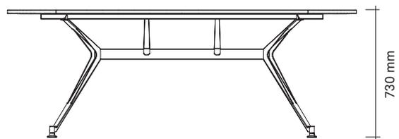
So einladend die Form, so nützlich die Details: LO D11 ist mit einem Bodengleiter ausgestattet, der den Tisch beinahe schwerelos über Teppich, Parkett und Beton gleiten lässt. Bei ungleichmässigen Böden ist eine Nivellierung bis 20 mm möglich, designintegriert und von oben zugänglich. Für Ordnung auf und unter dem Tisch sorgt die durchdachte Elektrifizierung.
